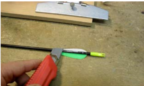
1 : retirer les plumes abimées, utiliser un cutter pour enlever le plus gros. Attention à ne pas attaquer le carbone.
